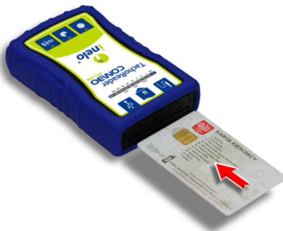
Obr. TachoReader Combo - vkládání karty řidiče.
