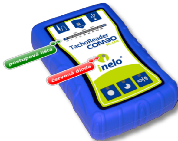
Obr. TachoReader Combo – umístění vybraných součástí.
